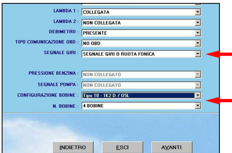
fig. 4-16 Procedura guidata – calibrazione impianto Plug&Drive MY10 Scorpio
